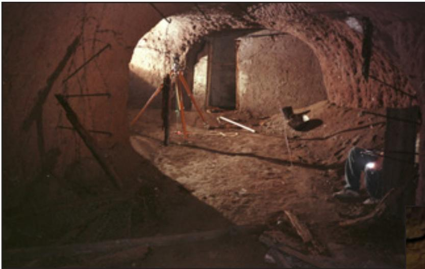
*Marzo 2001: Cave di Via C.A. Cortina. Uno dei primi ambienti della cavità; si vede il tacheometro con cui è stato fatto il rilievo di precisione
